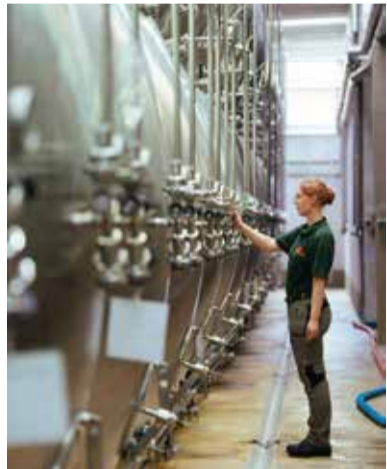
Großes Lernfeld auch für die Auszubildenden im Lehrberuf Fruchtsafttechnik der ORO: Der sterilisierte Apfelsaft wird nicht zu Konzentrat verdampft, sondern „pur“, so wie er ist, also als Direktsaft bis zur Abfüllung in den 2 Millionen Liter fassenden Edelstahltanks gelagert.
