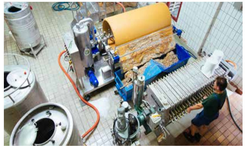
Modernste Keltertechnik (z. B. Dekanterpressung unter Luftabschluss), von der Pressung bis zur Filterung, gewährleisten höchste Saftqualität.
